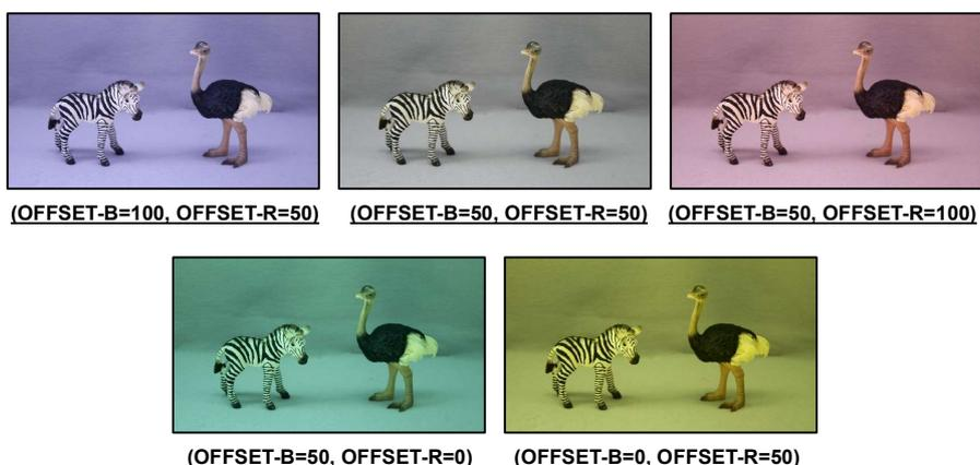
図 9. MODE = ATW, OFFSET-B/R を変更
